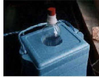
( 2 ) 低温の環境はペットボトルをまわりから冷やせばよいわけですから、まわりをドライアイスで囲めばそれで解決します。ドライアイスはマイナス約80度という低温ですから、簡単に、そして長い時間冷やしておくことができます。このとき、ペットボトルの下部の約3分の2をクーラーボックスにうめこみ、頭の丸い部分を蓋(ふた)の上に出した形にすることが大事な点です。上部は顔を出しているので、室温に近いのに対して、下の方はドライアイスで冷やされ、ペットボトルの中にはとても安定な空気の層ができます。つまり暖かくて軽い空気が上、冷たくて重い空気が底にたまることとなります。そこではほとんど空気が上下に移動しません。つまり安定な状態です。途中で結晶が成長するのに都合のいい温度の場所ができます。その場所を斜めから見下ろすというのがこの装置のポイントです。クーラーの蓋の高さの前後では1cmにつき6 ~ 7 くらいの割合で温度が下がっていきます。
